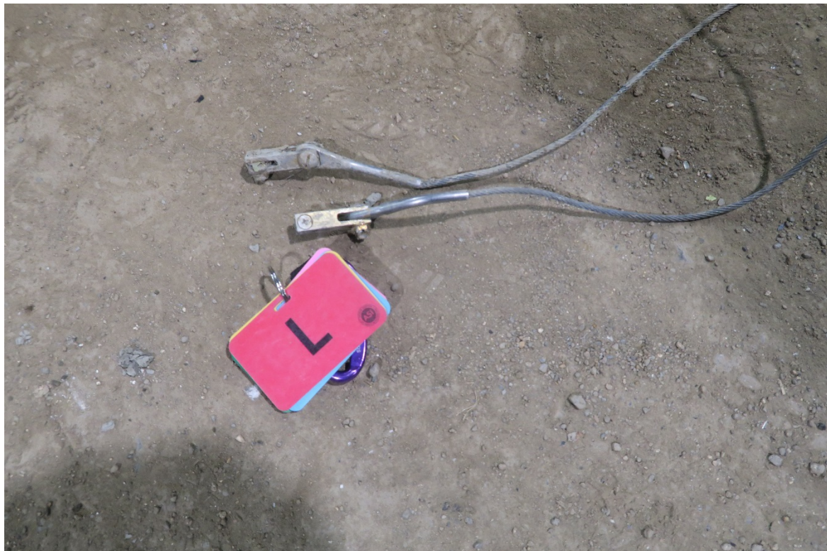
Left aileron cables, ASI-19-AE-066
