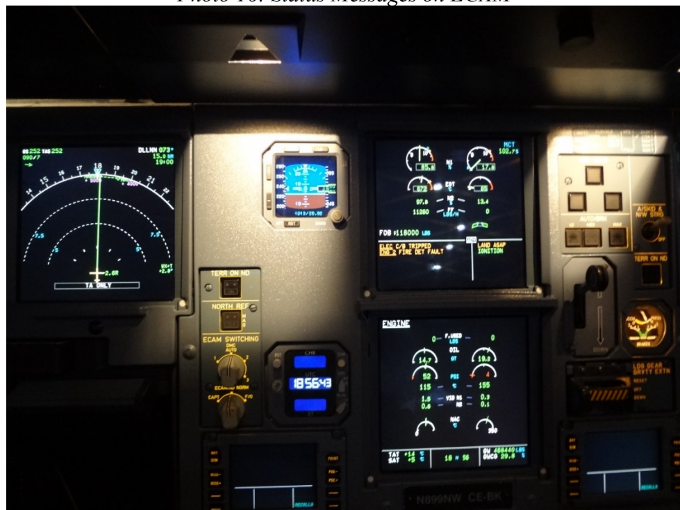
Photo 17: ENG 2 FIRE DET FAULT Message 11
