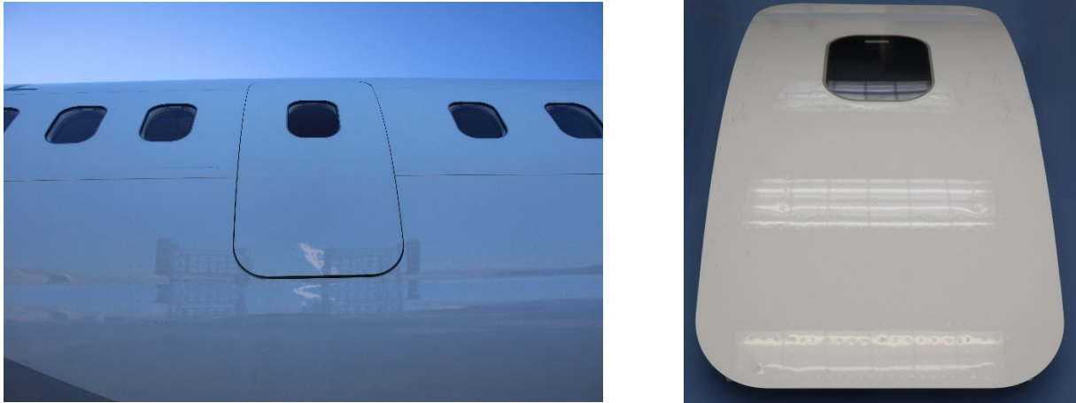
Figure 4. Left photo: Exemplar MED Plug installed on airplane. Right photo: Recovered LH MED Plug. [NTSB Photos]
