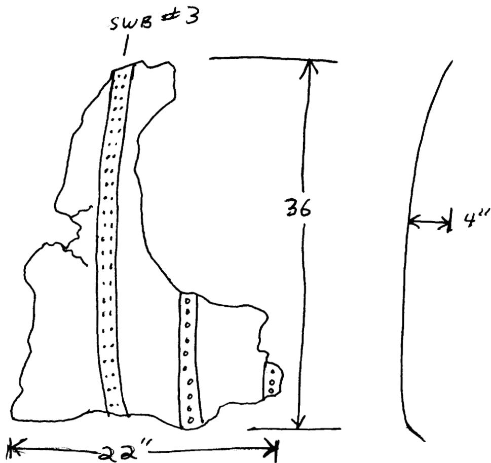
SIDE OF BODY RIB WEB, FROM THE RIGHT SIDE. PART IS APPROX 22" X 36". THERE ARE NO STIFFENERS ATTACHED.
