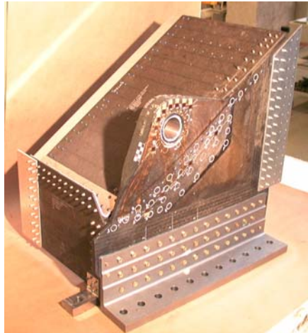
LHS Lug Test#2 specimen
