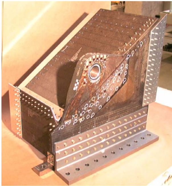
LHS Lug Test#2 specimen
