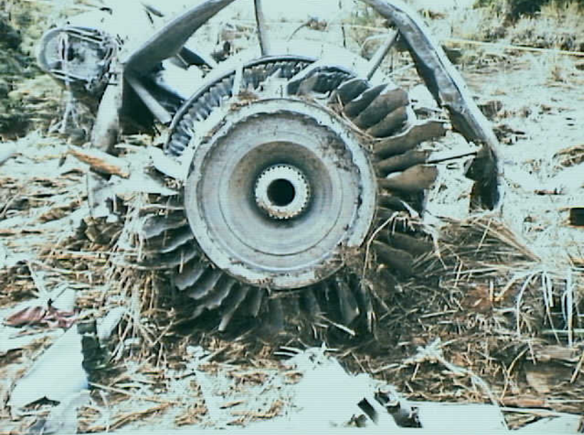
Powerplants 8 - Photo 17. No. 4 engine fan
