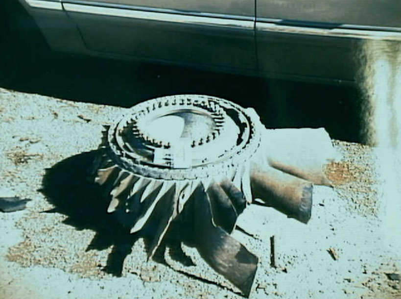
Powerplants 8 - Photo 15. No. 4 engine fan disk.
