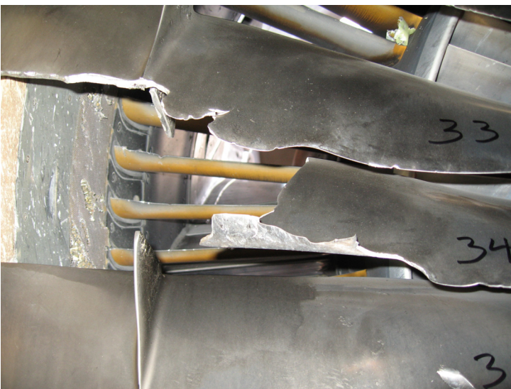
PHOTO 20: NO. 34 FAN BLADE FRACTURE
