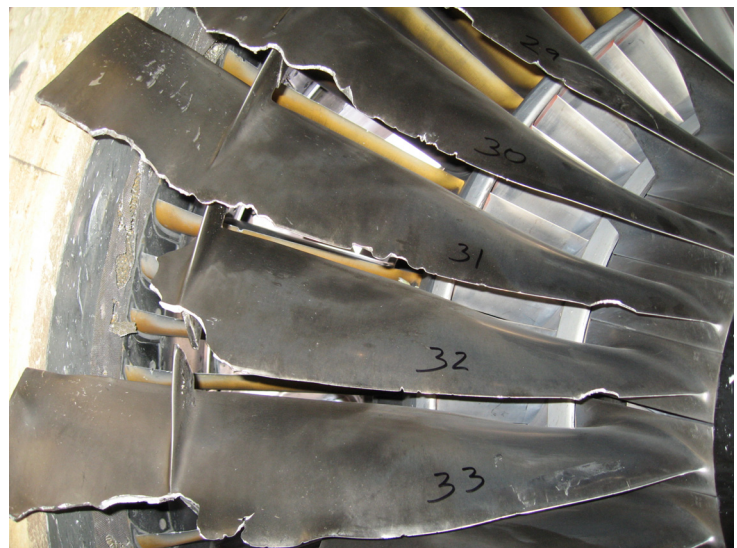
PHOTO 21: NO. 32 FAN BLADE FRACTURE
