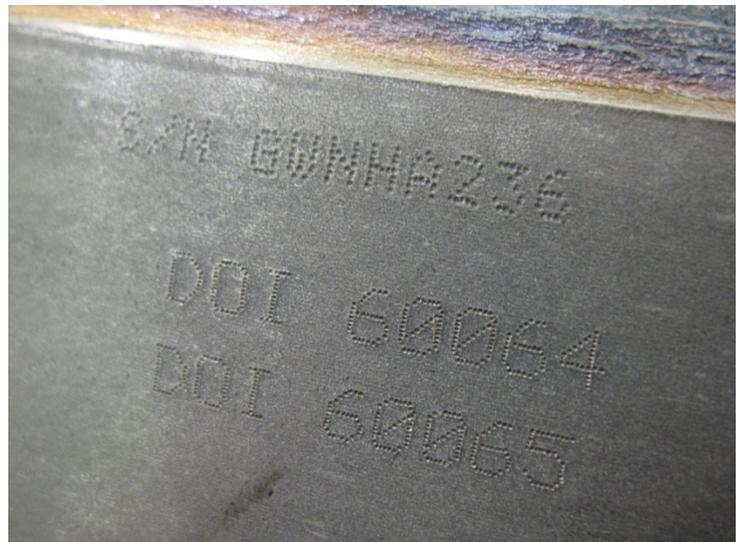
**PHOTO 2: PART MARKING ON THE HPC STAGE 8-10 SPOOL LOCATED ON THE REAR DRIVE ARM**
