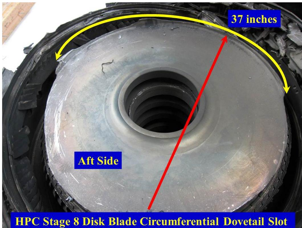
**PHOTO 52: HPC STAGE 8 DISK WITH 160° OF DOVETAIL SLOT RIM STILL ATTACHED**
