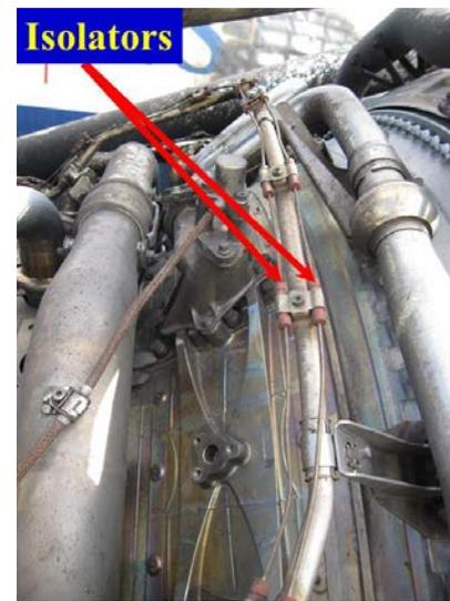
**PHOTO 42: FIRE LOOP ISOLATORS IN GOOD CONDITION**
