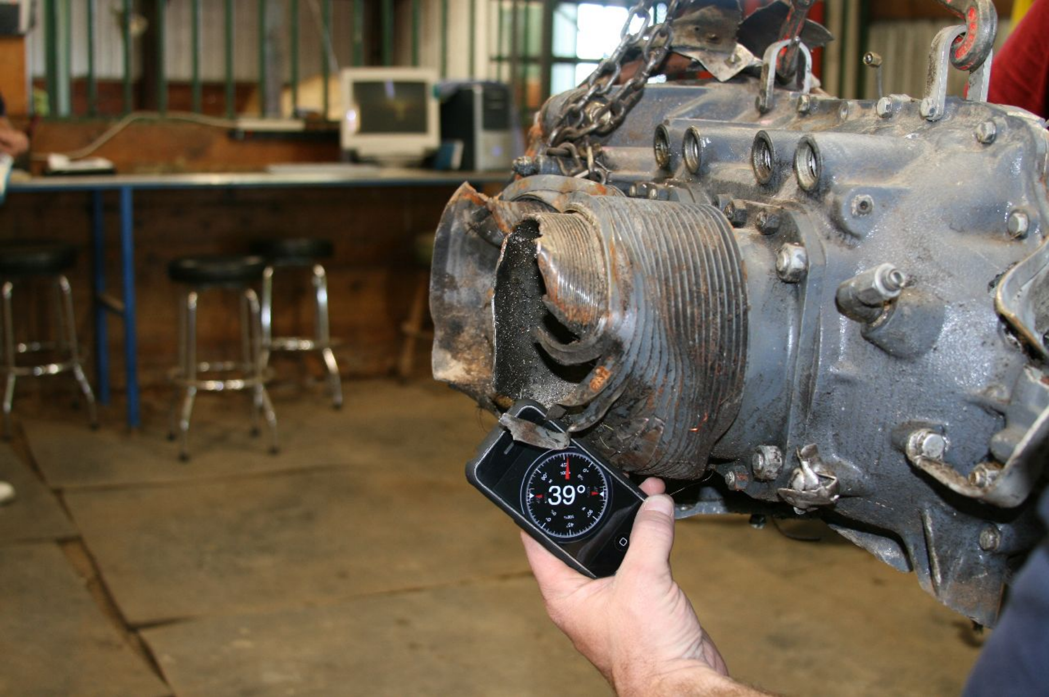
Photo 30. Cylinder 1 impact angle.
