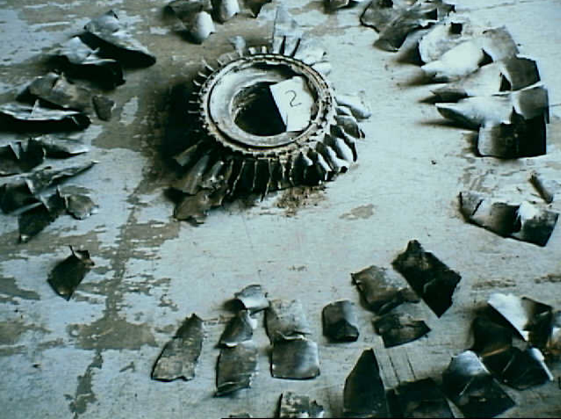
Photo 14. No. 2 engine fan hub and fan blade
