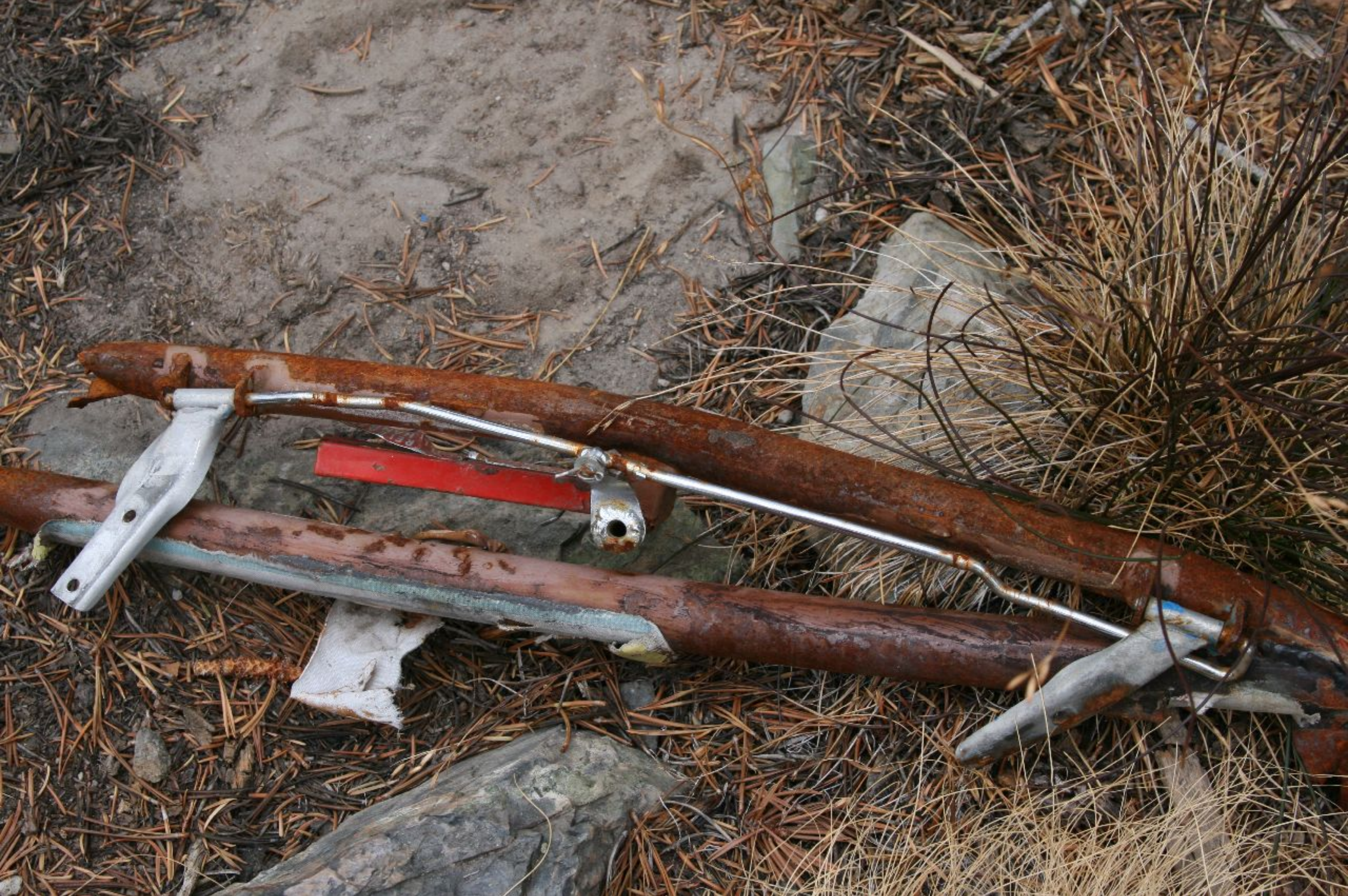
Photo 11. Cabin door hinge.
